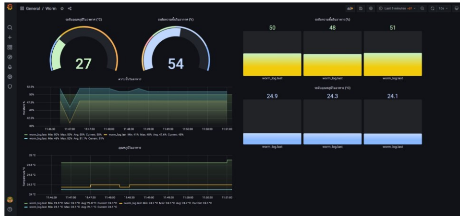
ภาพที่ 2 หน้าจอ (Dashboard) แสดงข้อมูลอุณหภูมิ ความชื้น ในภาคเลี้ยงแต่ละอัน
